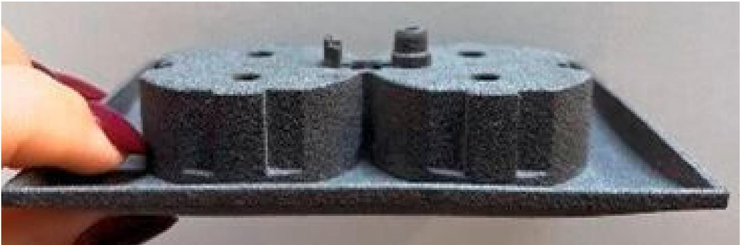
Selektives Lasersintern wird bei Kontakt-Simon eingesetzt, um neue Produkte schnell umzusetzen und zu validieren.
